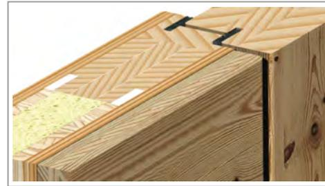
Detail: Standard-Türblatt Rohling mit Massiv-Altholz Applikation
